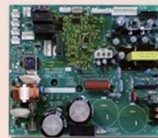
業務用冷蔵庫制御基板
